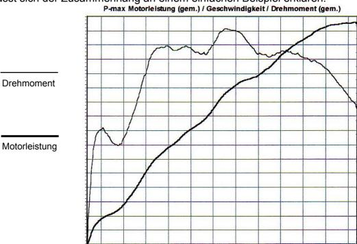
Im Bild lässt sich eindeutig der ungleichmäßige Drehmomentverlauf erkennen. Woran liegt das?
