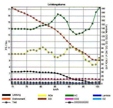
Der  $NO_x$ -Wert ist mit 600-800 ppm eindeutig zu hoch, normal wäre unter 400 ppm. Der HC-Wert ist mit 130-190 ppm vor Kat und unter Last zu niedrig. Ebenfalls zu niedrig ist der CO-Gehalt mit 2,5-2,8 Vol.%, normal wären hier zwischen 6 und 10 Vol.% vor Kat.
