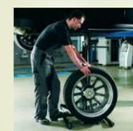
Mühselose Bedienung durch Fußschalter. Hubkraft: Räder bis 60 kg.
