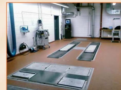
Prüfstraße mit Fahrwerktester BOGE und Senkschwelle, ohne Spurplatte
