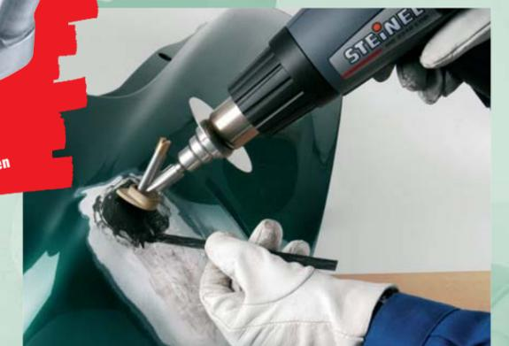
Bestehend aus dem leistungsstarken, elektronisch geregelten HG 2310 LCD inklusive dem notwendigen Zubehör zur mühelosen Instandsetzung typischer Kunststoffschäden. Eine schnelle Weiterverarbeitung ist gegeben.
